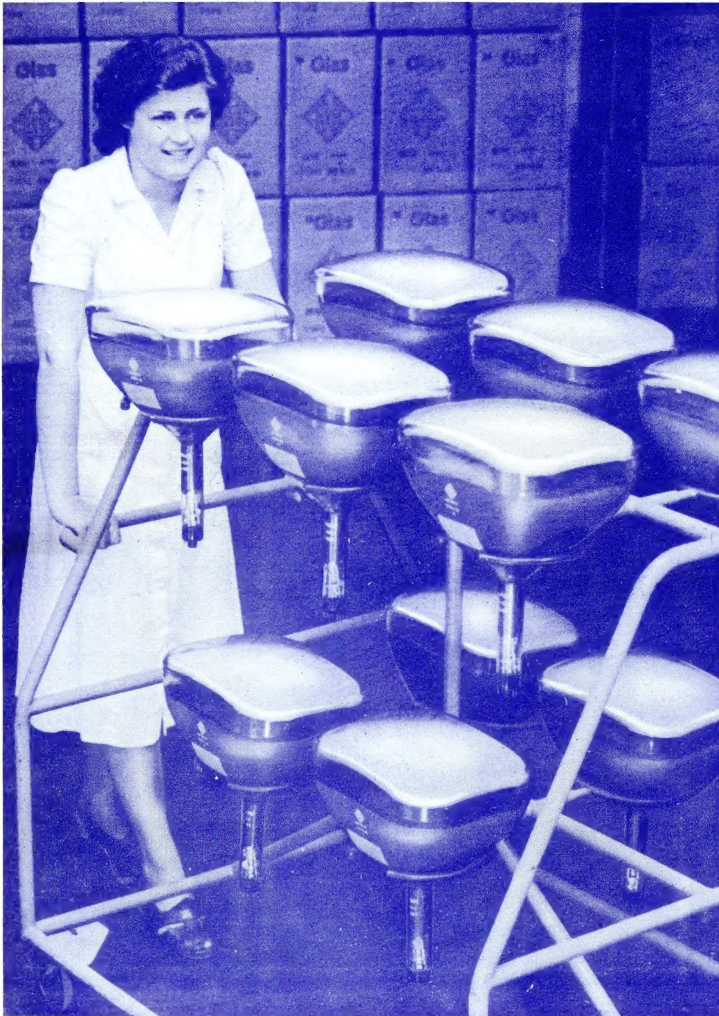
Fernseh-Bildröhren — bitte sehr! Die Serienfertigung von Bildröhren ist in Erwartung der großen Anforderungen im neuen Jahr überall angelaufen. Auf Stahlrohr-Fahrgestellen, gummigelagert, rollen die Röhren von der letzten Prüfung in die Versandabteilung.
